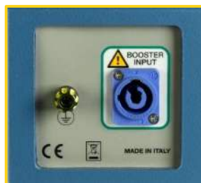
Figura 34 – Potenza sul pannello laterale
