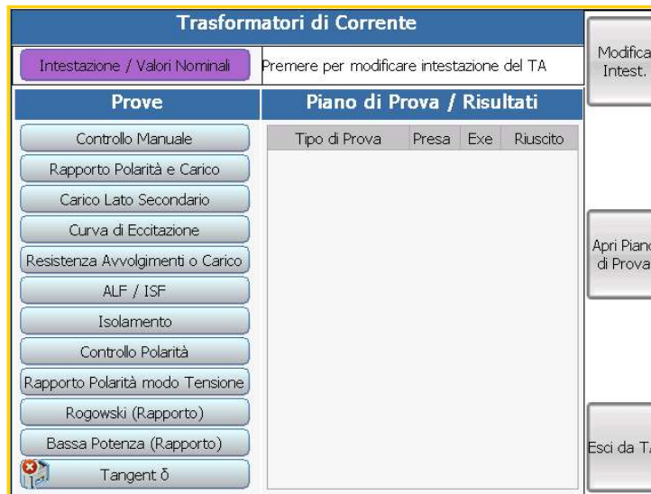
Figura 11–Pagina delle prove "Trasformatori di Corrente" (Convenzionali)
