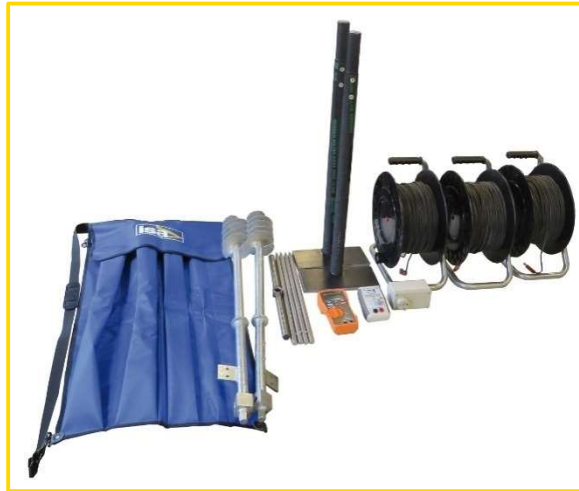
Figura 29 – Kit accesorios para ensayo malla de tierra
