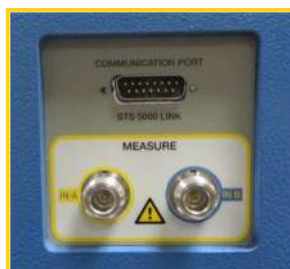
Figura 35 – Ingressi di misura IN-A (UST-A) ed IN-B (UST-B) sul pannello laterale
