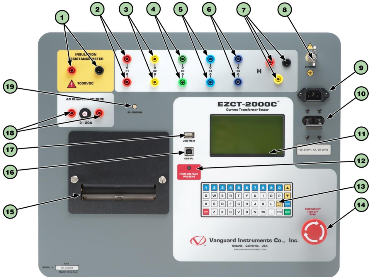
Figura 1. Controles e indicadores do EZCT-2000C
