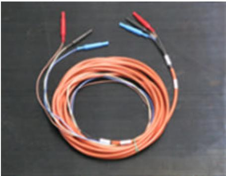
3. Due cavi con quattro conduttori ciascuno, per la connessione alle bobine dell'interruttore. Lunghezza: 10 m; sezione 1.5 mm<sup>2</sup>, terminate con boccole di sicurezza a banana di colore: nero, rosso, giallo, blu.
