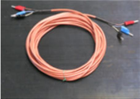
3. Due cavi con isolatori in silicone per la connessione ai contatti ausiliari, ognuno di tre conduttori. Lunghezza: 10 m; sezione 1 mm<sup>2</sup>; terminate con boccole di sicurezza a banana di colore: nero, rosso e blu.
