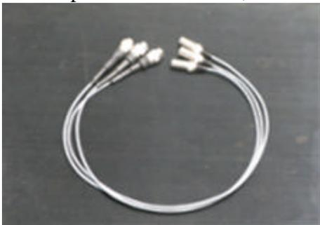
11. Tre adattatori per la connessione ai trasduttori analogici. Lunghezza: 1 m; terminate con un connettore a tre poli su un capo, e con quattro boccole a banana sull'altro capo.
